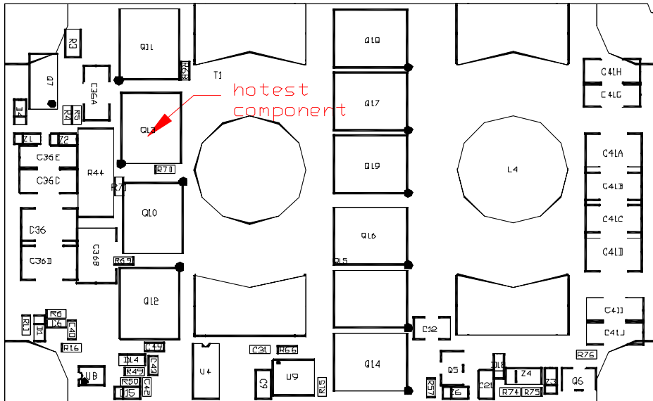
The hottest component on the top side: Q13
